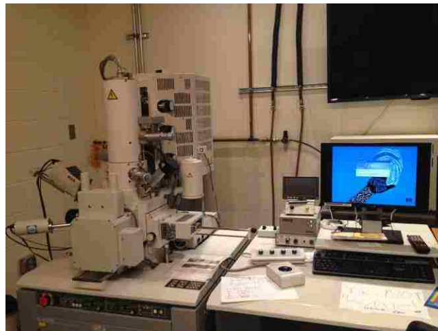
Figure 3.23. S-4700 model SEM (10 KV 12.0 mm x 60 SE (M))
